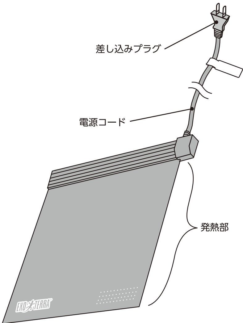
このたびは、「レプタイルヒート」をお買い上げいただき、ありがとうございます。本製品は、自動で温度を一定に保つ自己温度制御(PTC)ヒーターを採用した、ケージの下に敷いてケージ床面を温める爬虫類・両生類用のヒーターです。
