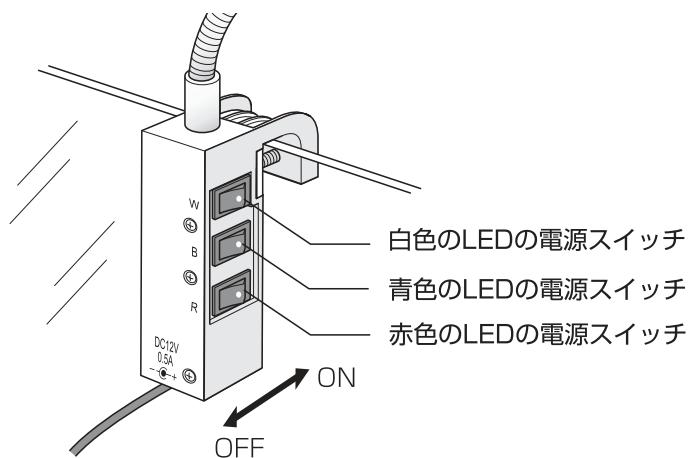
3. 本体側面の電源スイッチをONにする。
