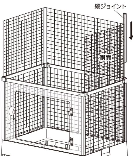
**11** 縦ジョイントの溝を側面に合わせて上から差し込み、上前板を縦ジョイントの溝に差し込んで連結する。
