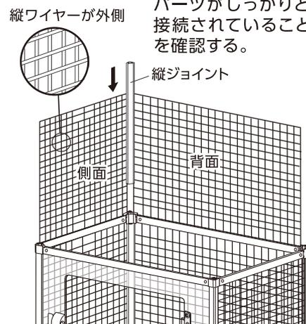
**10** 同様にもう一方の側面を乗せ、縦ジョイントを上部から差し込んで連結する。
