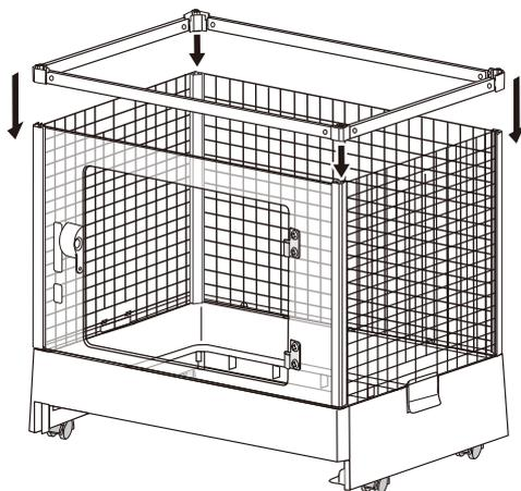
**9** 横ジョイントの溝に側面・背面を乗せ、縦ジョイントを上部から差し込んで連結する。
