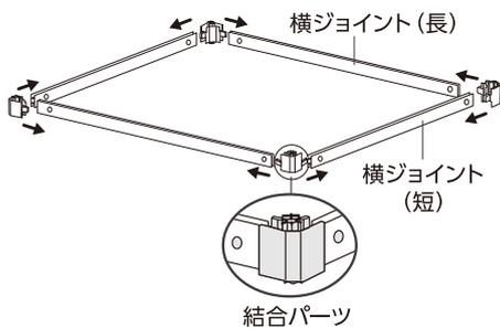
**8** 7で組み立てたものを、横ジョイントの溝に下前板・側面・背面がはまるように乗せ、縦ジョイントと結合パーツを接続する。
