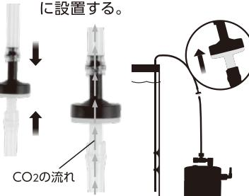
11 レギュレーターのバルブを2周回して開封した状態にする。およそ24時間でCO2の添加が始まる。必要に応じてバルブで添加量を調整する。
