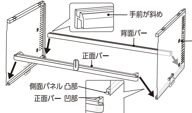
**2** 背面ガラスを側面パネルの隙間に上から差し込み、背面バーの溝にセットする。
