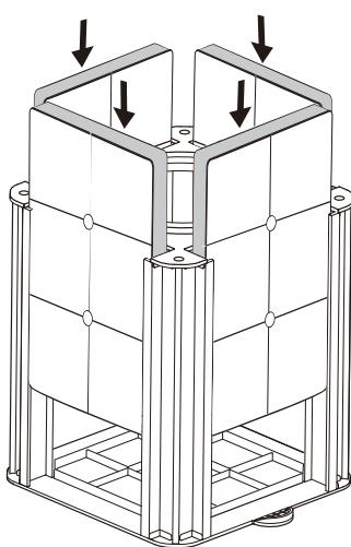
3 フィルターBOXを本体に奥まで差し込み、背面パネルを取り付ける。
