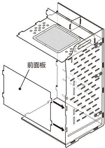
**7** 天面受けの連結爪(1ヶ所)を右側面板の連結穴に図のように差し込み、右側面板の外側からゴムリングで固定する。(1ヶ所)
