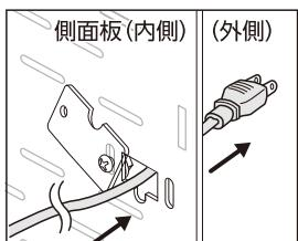
③コード穴プレートを元に戻してネジで固定する。
