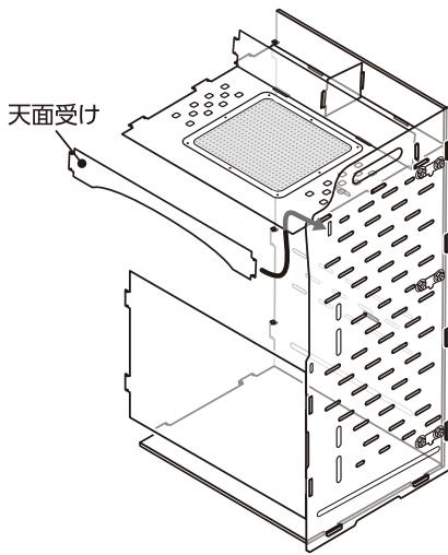
**8** ⑦で組み立てたものを右側面板を下にして置き、底面板の連結爪(2ヶ所)・背面板の連結爪(4ヶ所)・天面板の連結爪(3ヶ所)・棚前板の連結爪(1ヶ所)・天面受けの連結爪(1ヶ所)・前面板の連結爪(2ヶ所)を左側面板の連結穴に図のように差し込み、左側面板の外側からゴムリングで固定する。(13ヶ所)
