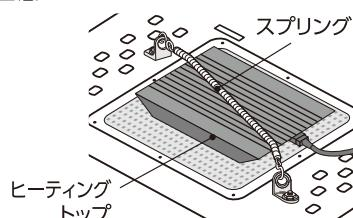
※メッシュ部分にスプリングを平行に取り付けると、バネの力が弱まりますので、必ず斜めにまたがるように取り付けてください。
