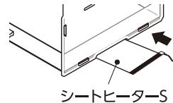
より大きいシートヒーターを使用する場合は前面より設置してください。
