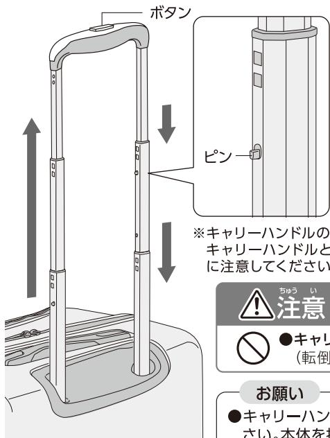
キャリーハンドルの長さを調節するときは、ボタンを押しながら一度パイプを最長状態まで引き上げ、下げながら固定する。
