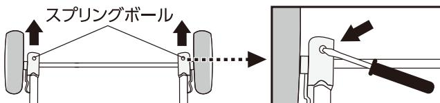
【後輪】ドライバー等の工具でスプリングボールをおさえながら、タイヤを引き抜く。
