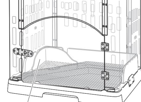
3 トイレをトイレ固定用フックで留める。(左側面と背面の2ヶ所)フックの長い方をベースの穴に、短い方をトイレ側面のフック穴に差し込む。
