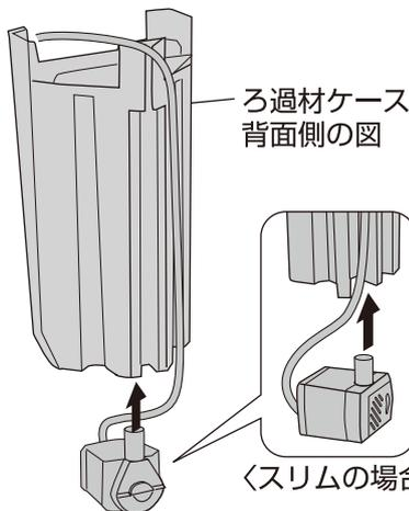
2. ろ過材ケースにモーターをセットする。図の向きでモーターをろ過材ケース下部に差し込む。
