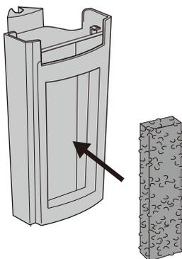
1. プレスポンジマットをろ過材ケースの内側に押し込んでセットする。
