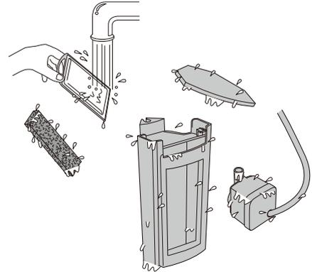
3. 本体内側、本体フタ、ろ過材ケース、専用ろ過材、プレスポンジマット、モーターを軽くすすぐ。
