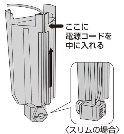
3. 電源コードを図のように、ろ過材ケース背面の溝に添わせてセットする。
