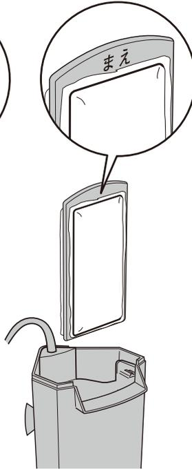
2. 専用ろ過材をセットするときは、図のようにマークがある側を手前にする。
