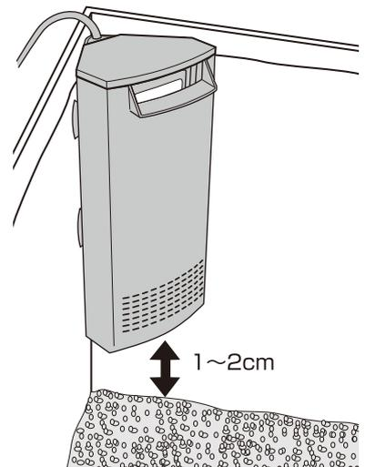
6. 水槽内のコーナーに本体後面のキスゴム（4コ）で本体を固定する。水槽の底から1~2cm以上離してセットする。
