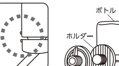
②ステンレスボールを指で押してパイプ内の空気を押し出し、空気が完全に抜けるまでボールを押し続ける。
