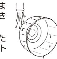
シャフト内部のベアリングには、金属パーツを使用しています。水で洗わないでください。ベアリング部分がぬれるとサビが発生し、異音などの原因になります。
