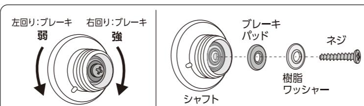
③ホイールとシャフトの凹凸を合わせて差し込み、シャフトネジで固定する。
