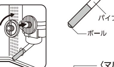
⑤初めてペットに使用する場合は、パイプから水が出ることを覚えさせてるために、ボールを押して水が出ることを教える。
