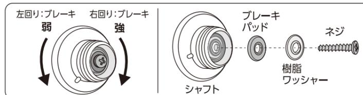
ネジの締め具合でブレーキの強弱を調整することができます。生体の走るスピードに合わせてブレーキの効き具合を調整してください。
