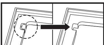
左図のように切り欠き部を折って取りはずすことで、コード穴を開けて電源コードやチューブを通すことができます。
