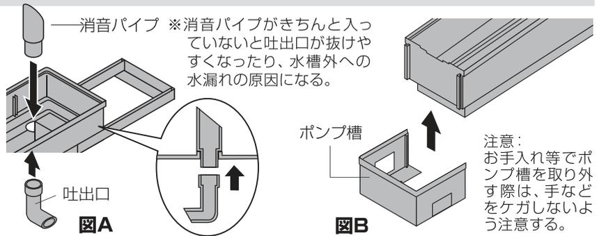
1. 消音パイプをフィルター本体の右側にある丸い穴に差し、吐出口を下からきちんと差し込む（図A）。そして、フィルター本体の左側にポンプ槽を差し込んでセットする（図B）。
