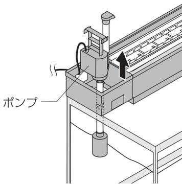
1.電源を切った後、ポンプ槽と本体のフタを取り、ポンプ槽よりポンプを取り出す。
