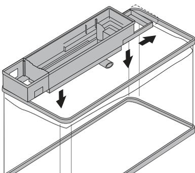
2. フィルター本体を水槽枠にのせながら、本体下部をスライドさせて水槽枠にはめる。
