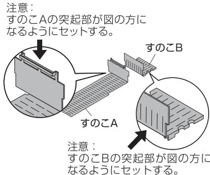
3. すのこA、すのこBは折り曲げるとき、図のように突起部の向きに注意して曲げる。
