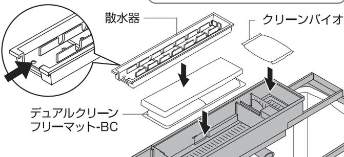
5. デュアルクリーンフリーマット-BCを置き、散水器を方向に注意（上図参照）してセットする。すのこBの上にクリーンバイオを置いてセットする。
