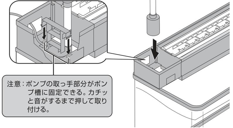
3.組み立てたポンプ部をポンプ槽の所定の位置に取り付ける。
