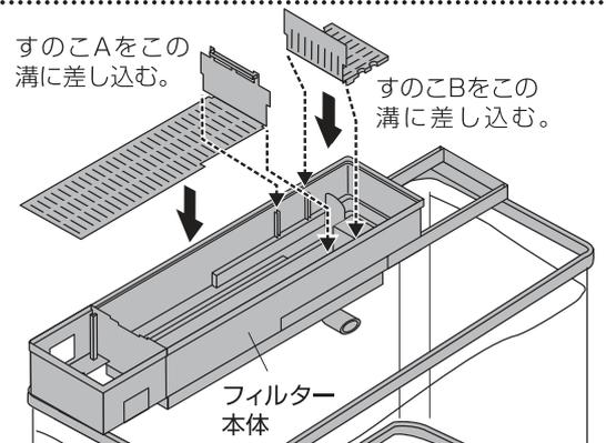
4. 折り曲げたすのこA、すのこBをフィルター本体の溝に合わせてセットする。
