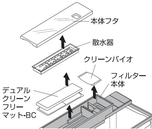
1.電源を切った後、本体フタ、散水器を取り、デュアルクリーンフリーマット-BC、クリーンバイオをフィルター本体から取り出す。
