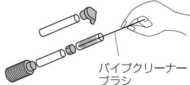
2.ストレーナー、吸水パイプ、送水パイプ、送水口、パイプジョイントはパイプクリーナーブラシ (別売) で定期的に洗浄する。
