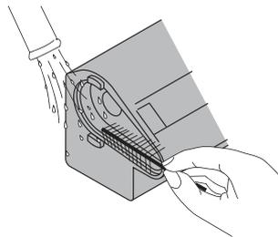
4.インペラーユニットの汚れを水洗いする。インペラーカバー、ポンプ室カバーも洗う。ポンプ内部もパイプクリーナーブラシ (別売) などで汚れを落とす。汚れを落とした後、逆の手順で戻す。
