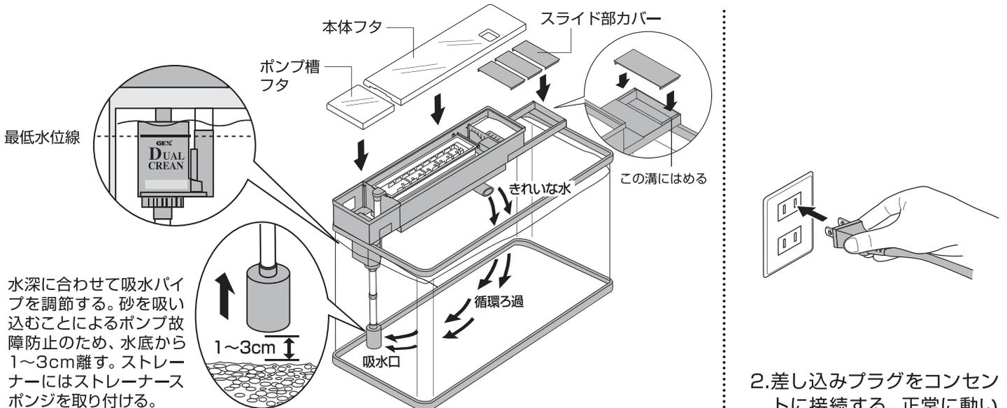
1.本体フタ、ポンプ槽フタをセットし、水槽の大きさによって本体のスライド部が開いている場合、必要に応じてスライド部カバーでフタをする。**ポンプの最低水位線以上に水があることを確認する。**
