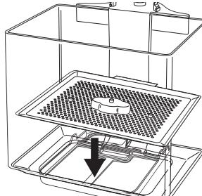
4. ろ過ケースを斜めに傾けながら水槽ベースの枠にはめ込んでセットする。
