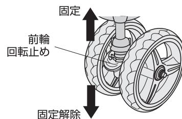
1. 前輪回転止めを引き上げると前輪が横回転しなくなり、直進方向にのみ進むようになる。
