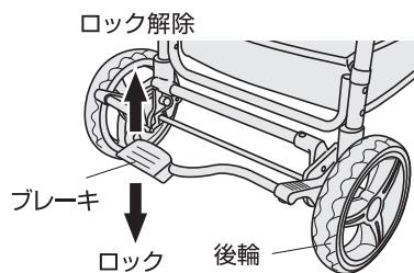
1. ブレーキを下げるとき、左右後輪のブレーキ溝にブレーキの両端がはまり後輪がロックされる。
