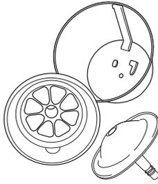
4. 専用フィルターとポンプ以外を、薄めた中性洗剤を含ませたスポンジで洗浄します。研磨剤は使用しないでください。洗浄後は十分に洗い流してください。
