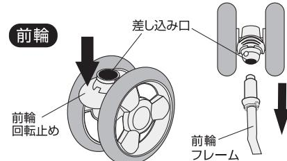
B 前輪回転止めを押し下げた状態にします。右上の図のように差し込み口を下にして、前輪フレームにカチッと音がするまで差し込みます。前輪が簡単に外れないことを確認してください。
