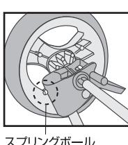
A 後輪のロックレバーがフレームの後ろ側にくる向きで、カチッと音がするまで後輪フレームに差し込みます。上図のように、スプリングボールが所定の位置に差し込まれ、後輪が簡単に外れないことを確認してください。
