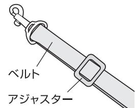
ペットを乗せる時は、必ず飛び出し防止リードをペットが装着している首輪、胴輪などに取り付けてください。その際、ベルトをペットが飛び出さない長さに調節してください。
