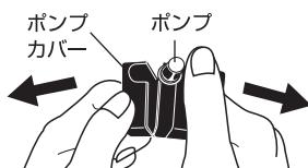
図のようにポンプを持ち、矢印の向きに力を入れて、ポンプカバーを取り外します。
