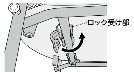
**C** 後輪側のフレームにロック受け部をはめ込み、ロックを閉じます。カチッと音がして、ロックされていることを確認してください。
