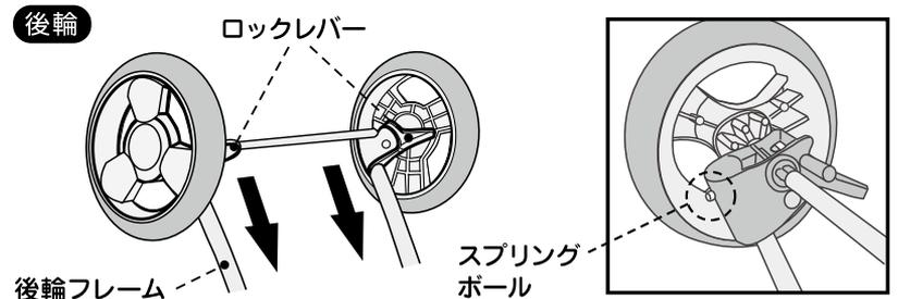
**A** 後輪のロックレバーがフレームの後ろ側にくる向きで、カチッと音がするまで後輪フレームに差し込みます。上図のように、スプリングボールが所定の位置に差し込まれ、後輪が簡単に外れないことを確認してください。
