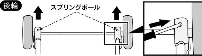
■ドライバー等の工具でスプリングボールをおさえながら、タイヤを引き抜きます。
