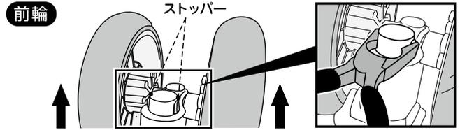
■フレームのストッパーをベンチ等ではさみながらタイヤを引き抜きます。
