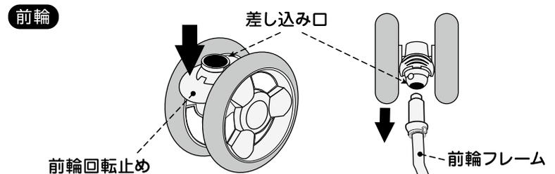
**B** 前輪回転止めを押し下げた状態にします。右上の図のように差し込み口を下にして、前輪フレームにカチッと音がするまで差し込みます。前輪が簡単に外れないことを確認してください。
