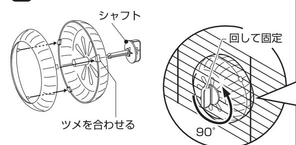
回転輪本体の3ヶ所のツメを合わせ、押し込んで固定する。次にシャフトを上図のように回転輪が床材などにあたらなないようにシャフトの位置を調整してケージのワイヤーに差し込み、図bのようにシャフトを回して固定する。
