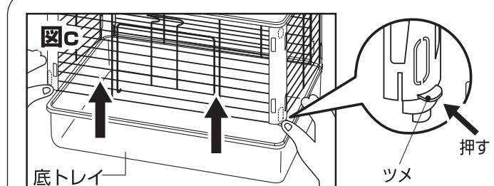
図cのように前面の柱下のツメを親指で押しながら上にあげ、取り外す。
