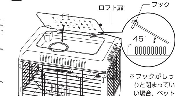
斜め45°の角度からロフト扉を差し込んで扉を下におろし、“バチン”と音ができるまで前のフックを指で押すと固定される。
