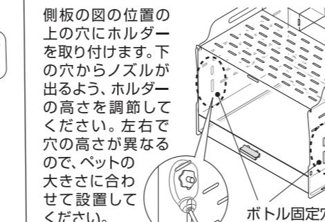
側板の上の穴にホルダーを取り付けます。下の穴からノズルが出るよう、ホルダーの高さを調節してください。左右での穴の高さが異なるので、ペットの大きさに合わせて設置してください。
