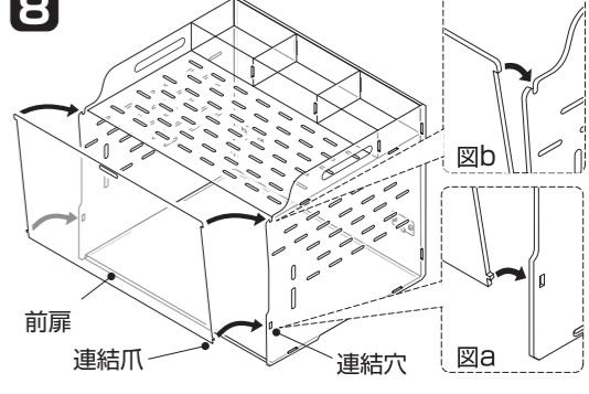
7で組み立てたものを底板を下にして置き、前扉下部の連結爪を左右側板の連結穴にはめ込み(図a)、前扉上部の爪を左右側板の切り込みに引っかける。(図b)
