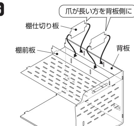
棚仕切り板2枚の連結爪(短い方)を棚前板の連結穴に差し込み、連結爪(長い方)を背板の連結穴に差し込む。(ここはゴムリングで固定しない)
