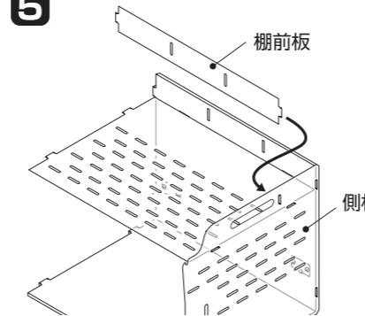
4で組み立てたものを底板を下にして置き、棚前板の連結爪を側板の連結穴に差し込み、側板の外側からゴムリングで固定する。(1ヶ所)
