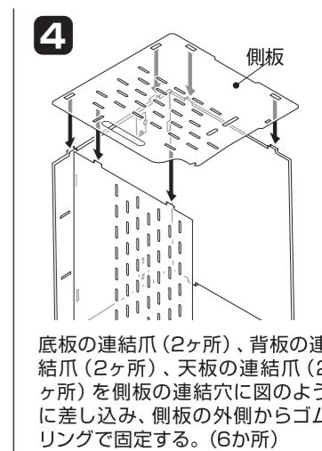
底板の連結爪(2ヶ所)、背板の連結爪(2ヶ所)、天板の連結爪(2ヶ所)を側板の連結穴に図のように差し込み、側板の外側からゴムリングで固定する。(6ヶ所)
