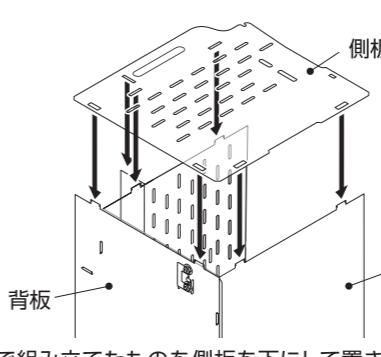
6で組み立てたものを側板を下にして置き、底板の連結爪(2ヶ所)、背板の連結爪(2ヶ所)、天板の連結爪(2ヶ所)、棚前板の連結爪(1ヶ所)をもう一枚の側板の連結穴に図のように差し込み、側板の外側からゴムリングで固定する。(7ヶ所)
