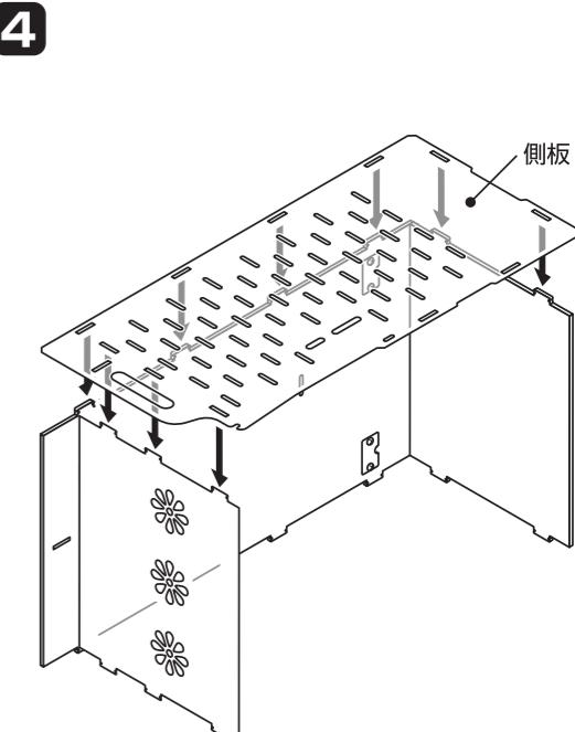
底板の連結爪(2ヶ所)、背板の連結爪(4ヶ所)、天板の連結爪(3ヶ所)を側板の連結穴に図のように差し込み、側面の外側からゴムリングで固定する。(9ヶ所)
