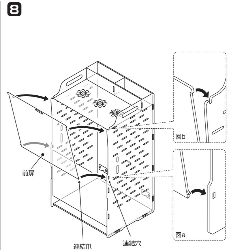
7で組み立てたものを底板を下にして置き、前扉下部の連結爪を左右側板の連結穴にはめ込み(図a)、前扉上部の爪を左右側板の切り込みに引っかける。(図b)
