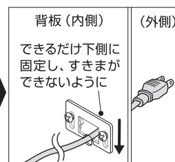
③コード穴プレートを元に戻してネジで固定する。
