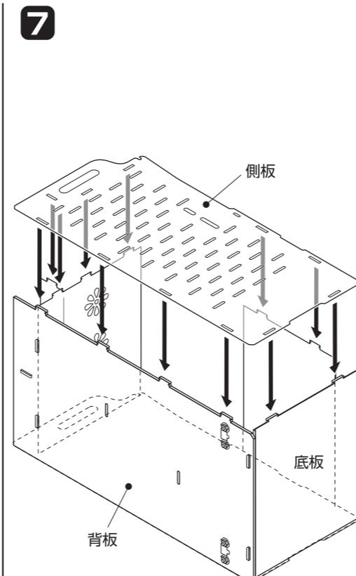
6で組み立てたものを側板を下にして置き、底板の連結爪(2ヶ所)、背板の連結爪(4ヶ所)、天板の連結爪(3ヶ所)、棚前板の連結爪(1ヶ所)、前板の連結爪(2ヶ所)をもう一枚の側板の連結穴に図のように差し込み、側板の外側からゴムリングで固定する。(12ヶ所)
