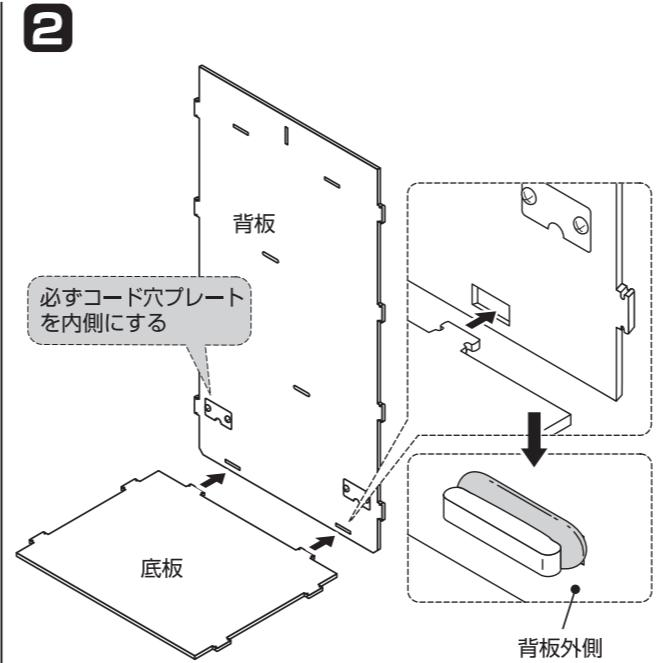
底板の連結爪(2ヶ所)を背板の連結穴に差し込み、背板の外側からゴムリングで固定する。(2ヶ所)
