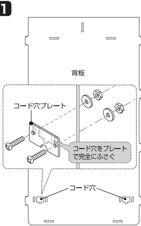
背板のコード穴にコード穴プレートをあて、プレート側からネジ、反対側からワッシャーとナットで固定する。(2ヶ所)
