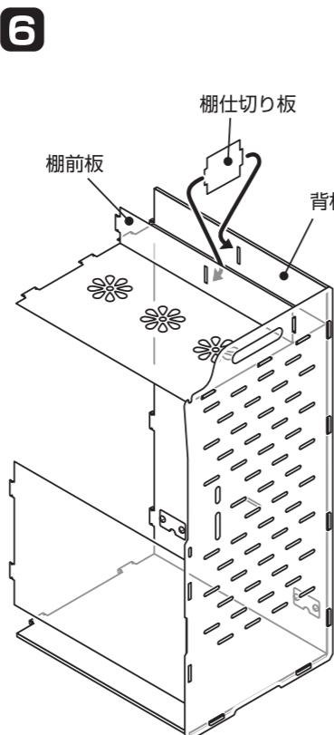
4で組み立てたものを底板を下にして置き、前板の連結爪(2ヶ所)、棚前板の連結爪(1ヶ所)を側板の連結穴に図のように差し込み、側板の外側からゴムリングで固定する。(3ヶ所)
