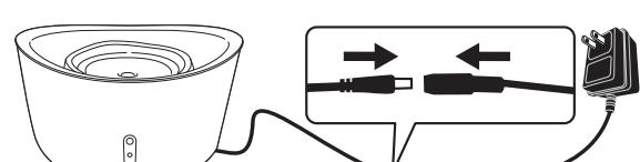
8. ACアダプターのジャックとコード付ポンプのプラグをつなぎ、ACアダプターをコンセントに差します。
