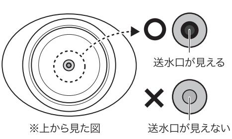
6. 上からのぞいて、トップファンネルとポンプの送水口がずれていないかを確認してください。ずれていると、水が正しく流れません。
