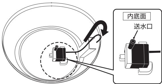
1. ベースタンクの内底面に吸盤(キスゴム)でポンプを設置し、図のようにコードを沿わせます。
