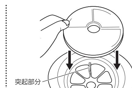
4. フィルターの不織布を上側に向けて、底面の凹みがトレイの突起部分にくるようセットします。
