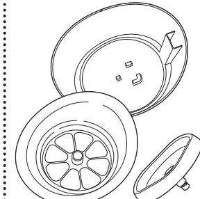
4. 専用フィルターとポンプ以外を、薄めた中性洗剤を含ませたスポンジで洗浄します。研磨剤は使用しないでください。洗浄後は十分に洗い流してください。
