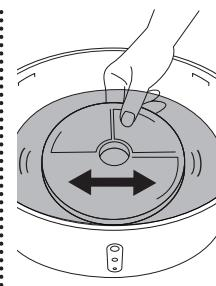
5. 水道水を溜めた容器にフィルターを沈め、数回ゆり洗いをくり返して活性炭の微細粉が出なくなるまで洗い流してください。
