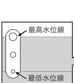
7. トップファンネルの周囲から水を注ぎ、水位目盛の最高水位線まで給水します。
