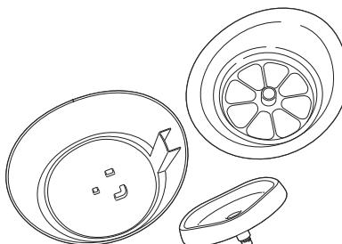
セットアップと逆の手順で各パーツを取り外し、薄めた中性洗剤を含ませたスポンジで洗浄してください。研磨剤は使用しないでください。洗浄後は十分に洗い流してください。
