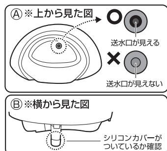
6. ファンネルの穴にポンプの送水口がはまるようにベースタンクにセットします。
