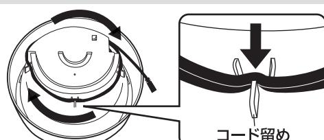
設置する場所から電源コードの長さを決定し、不要なコードはベースタンク底部に図のように巻いて長さを調節してください。
