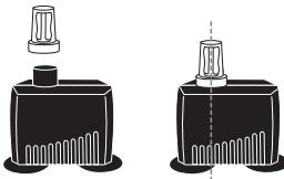
1.ポンプに付属のポンプトップを取り付けます。図のように必ずポンプトップの柱が正面になるようにしてください。
