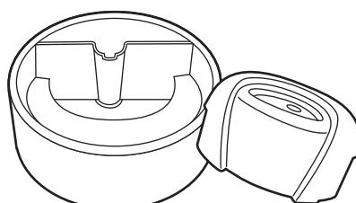
セットアップと逆の手順で各パーツを取り外し、薄めた中性洗剤を含ませたスポンジで洗浄してください。研磨剤は使用しないでください。洗浄後は十分に洗い流してください。夏場は水がいたみやすいので毎日、洗浄及び水の交換をしてください。お手入れ不足の場合はカビ等の雑菌が発生し、変色することがあります。
