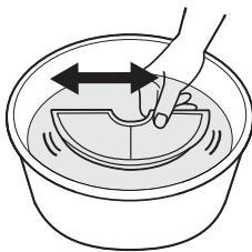
2. 水道水を溜めた容器にフィルターを沈め、数回搖り洗いをくり返して活性炭の微粉やイオン交換樹脂の黄色の水<sup>※1</sup>が出なくなるまで洗い流してください。(※Q&A⑨、⑯)
