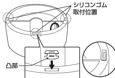
2.ベースタンク用のシリコンゴムをベースタンクの凹部(3箇所)に取付けます。図のように必ず凸部がベースタンクに対して外向きになるようにしてください。
