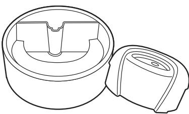
1. ファンネル、ベースタンク、ポンプを薄めた中性洗剤を含ませたスポンジで洗浄します。研磨剤は使用しないでください。
