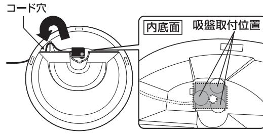
3.ベースタンクのコード穴にポンプの電源コードを通してから、ポンプを図のように枠内の丸い吸盤取付位置にあわせて、吸盤をしっかりと固定してください。
