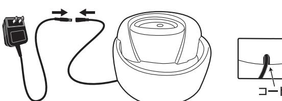
7. ACアダプターのプラグとコード付ポンプのジャックをつなぎ、ACアダプターをコンセントに差します。
