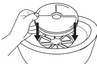
4. 専用フィルターのプラスチックの面を下側に向けてセットします。
