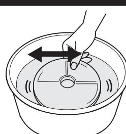
専用フィルターのお手入れの際には、洗剤を使用しないで水で表面の汚れを洗い流してください。特に夏場は虫が発生する可能性がありますので毎日の洗浄をおすすめします。
