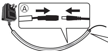
7. ACアダプターにコード保護チューブを通してつなぎます(A)。このプラグとジャックの接続部をコード保護チューブ内に収めてください。
