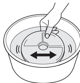
5. 水道水を溜めた容器にフィルターを沈め、数回搖り洗いを繰り返してください。
