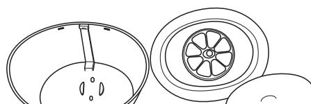
4. 専用フィルターとポンプ以外を薄めた中性洗剤を含ませたスポンジで洗浄します。研磨剤は使用しないでください。洗浄後は、十分に洗い流してください。
