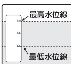
6. トップファンネルの噴水口から水を注ぎ、水位目盛の最高水位線(MAX)まで給水します。
