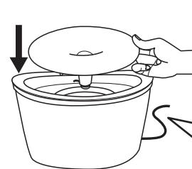
5. トップファンネルをセットします。上からのぞいて、トップファンネルとポンプの送水口がずれていないかを確認してください。ズレていると水が正しく流れません。
