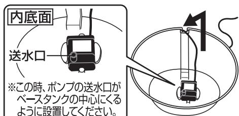
1. ベースタンクの内底面に吸盤(キスゴム)でポンプを設置し、コードカバーの溝にコードを沿わせます。
