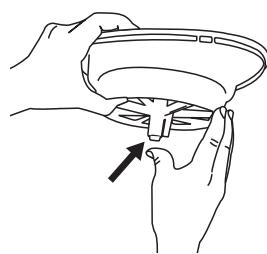
2. トップファンネルをはずします。(両手でフィルタートレイを持ち、トップファンネル裏側の先端部分を指で軽く押してください。)
