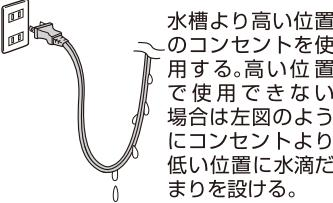
水槽より高い位置のコンセントを使用する。高い位置で使用できない場合は左図のようにコンセントより低い位置に水滴だまりを設ける。</p> |
