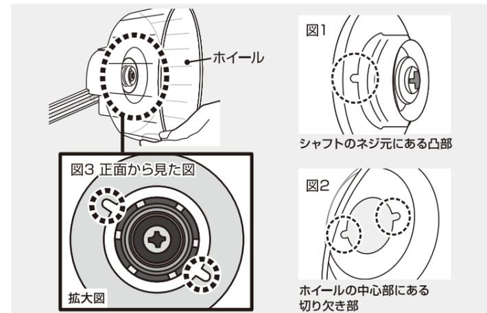
③ずれないようにホイールを持ちながら、シャフトネジを回して締める。
