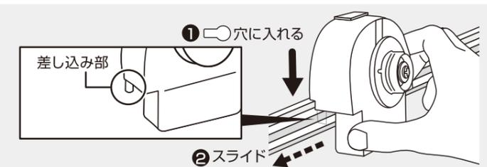
②ホイールを持ち、シャフトにホイールをセットする。ホイールをはめ込むときに、シャフトのネジ元にある凸部(図1)と、ホイール中心部にある切り欠き部(図2)がきちんとはまっているかを必ず確認する。(図3点線部)
