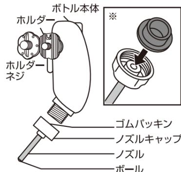
②ウォーターボトルを取り付けたい側のボトル取り付け穴(Highの場合は3ヶ所の内の2つ)の専用キャップを取り外す。
